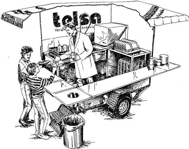
Die **telsa**-Spülstation besteht aus einem Anhänger, auf dem eine Haubenspülmaschine für Geschirr und Gläser fest montiert ist.
